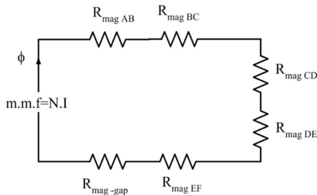
شكل ١ - ٣ الدائرة الكهربية المكافئة لدائرة التوالي المغناطيسية الموضحة في شكل ١ - ٢
